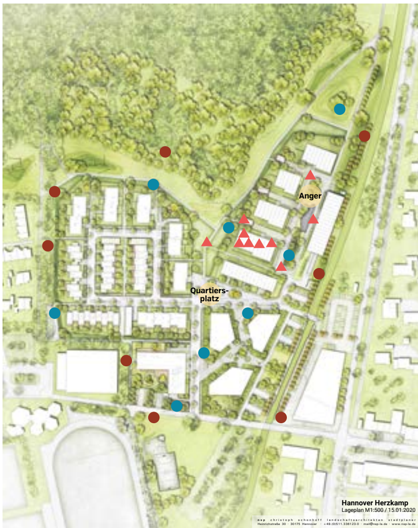
Abb. 38: Messnetz im Quartier Herzkamp (Klima/Thermischer Komfort: rote Dreiecke; Regenwasserversickerung: blaue Punkte; Grundwasser: braune Punkte), [Plandarstellung: nsp]
