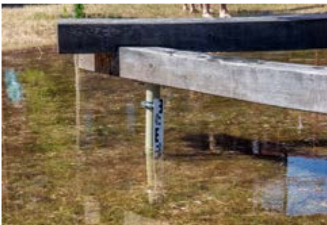
Abb. 40: Pegelmessstellen im Herzkamp [Foto: Czorny]
